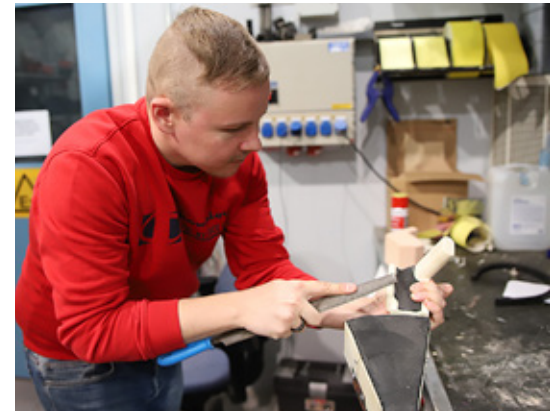
Industriedesigner Henri Hokkanen arbeitet an einem Kunststoffmodell einer Armlehne. Im Designstudio werden viele Kunststoff-, Holz- und 3D-gedruckte Komponenten verwendet, um Modelle von zukünftigen Traktoren und Kabinen in Originalgröße herzustellen.
